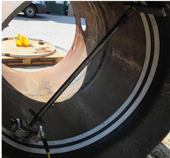
Spannband, Stützfuß, Spindelgestänge und Expander sind auf einer Geraden.
