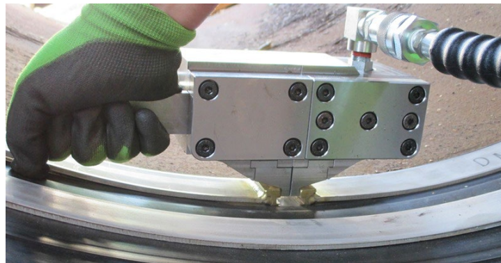
Richtig: mittiges Setzen des Expanders!
