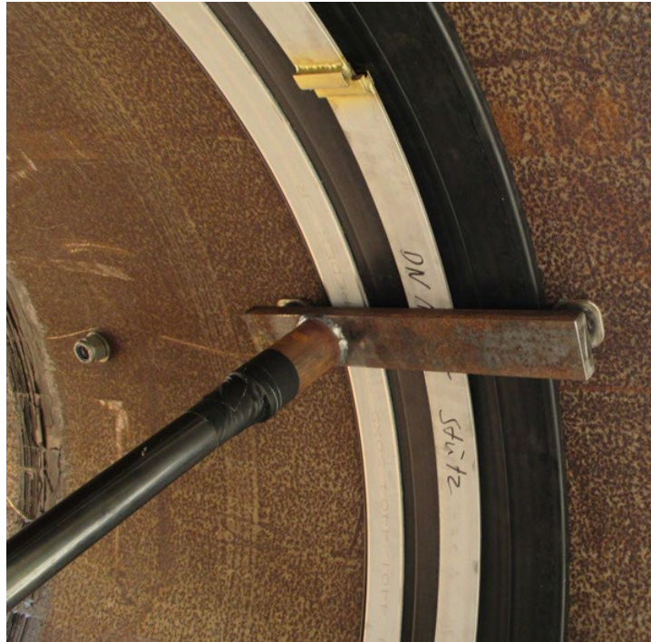
Achse: Spannband, Spindel und Expander.
