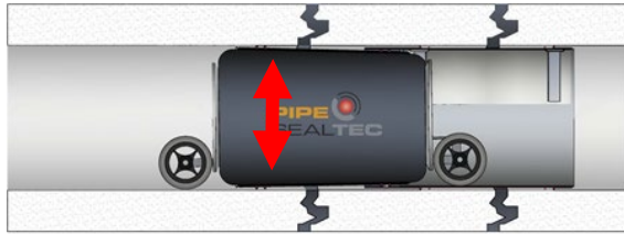
Abbildung 78: Aufweiten an Einbauort – Montage der Abschlusshülse
