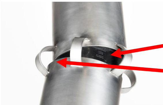
Abbildung 86: Versuchsaufbau axiale und radiale Richtungsänderung (Abwinklung und Versatz)
