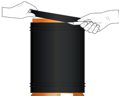
Abbildung 50: Umlaufendes Kürzen des überstehenden Gummis
