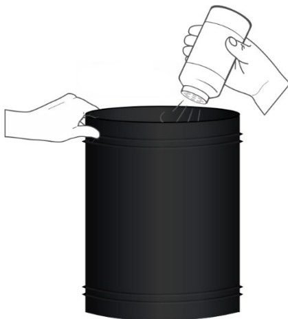
Abbildung 46: Gummidichtung mit Talkum benetzen
