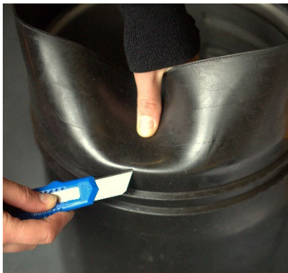
Abbildung 49: Einfaches Kürzen des überstehenden Gummis
