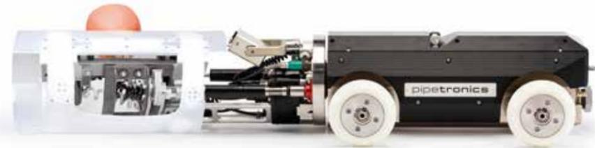
Das PI.TRON Verpressverfahren ermöglicht eine saubere und kraftschlüssige Reparatur von unterschiedlichen Schadensstellen in Kanälen DN 200 gelinert bis DN 800 und in gängigen Eiprofilen:
